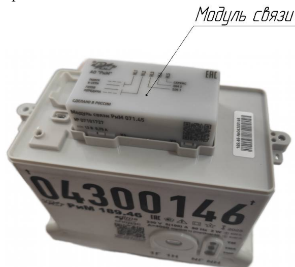
Рисунок Б.1 – Установка модуля связи в счетчик
