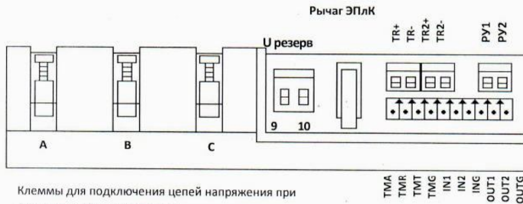
Рисунок Г.3 – Схема расположения контактов клеммной колодки счетчиков РИМ 489.13, РИМ 489.15, РИМ 489.17
