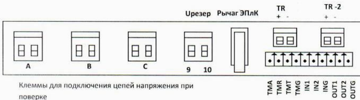
Рисунок Г.1 - Схема расположения контактов клеммной колодки счетчиков РИМ 489.14, РИМ 489.16
