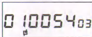
Рисунок 6 – Пример индикации заводского номера счетчика, с которого считываются показания (в примере – заводской № 1005403)
