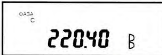
Рисунок 18 - Пример индикации среднеквадратического значения напряжения по фазе С
