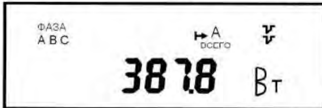
Рисунок 12 - Пример индикации значения суммарной активной мощности
