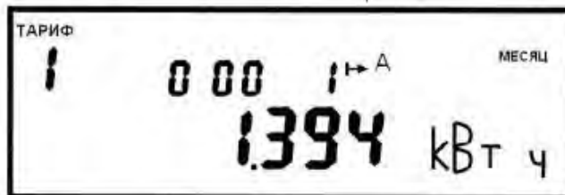
Рисунок 7 – Пример индикации значения потребления активной энергии на РДЧ по 1 тарифу. В поле «Дата/Время» индицируется РДЧ
