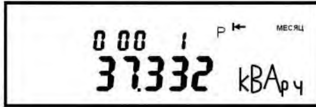
Рисунок 9 - Пример индикации значения емкостной реактивной энергии на РДЧ. В поле «Дата/Время» индицируется РДЧ
