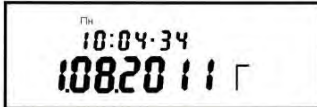
Рисунок 14 - Пример индикации текущей даты и времени ЧРВ счетчика
