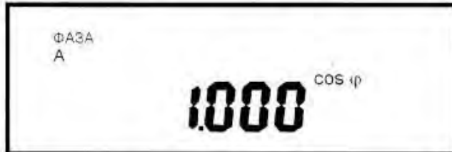
Рисунок 16 - Пример индикации значения коэффициента мощности по фазе А
