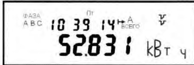
Рисунок 10 - Пример индикации значения суммарного потребление активной энергии по всем тарифам
