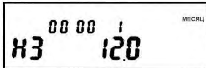
Рисунок 22 - Пример индикации времени подачи некачественной энергии на РДЧ
