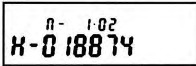
Рисунок 4 – Пример индикации номера версии и заводского номера счетчика (версия счетчика 1.02, заводской номер 018874)
