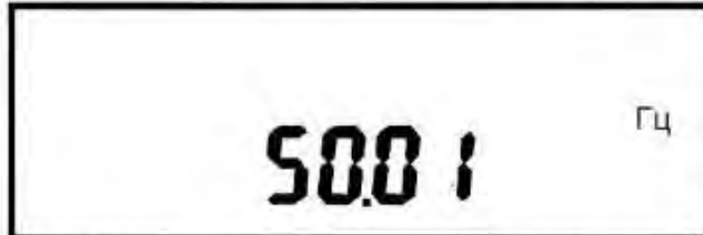
Рисунок 15 - Пример индикации значения частоты сети
