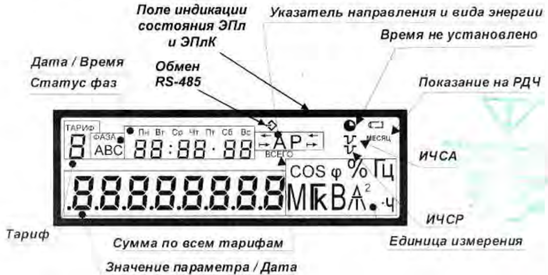
Рисунок 3 – Расположение полей дисплея счетчика
