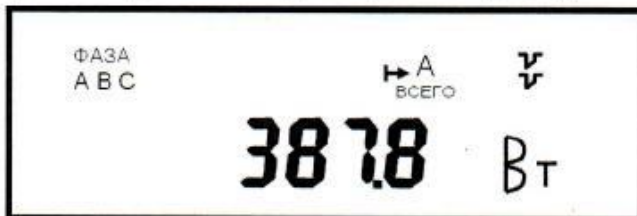
Рисунок 12 - Пример индикации значения суммарной активной мощности
