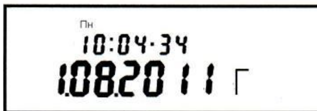
Рисунок 14 - Пример индикации текущей даты и времени ЧРВ счетчика
