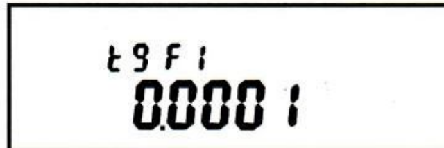
Рисунок 21 - Пример индикации суммарного значения коэффициента реактивной мощности цепи tg φ
