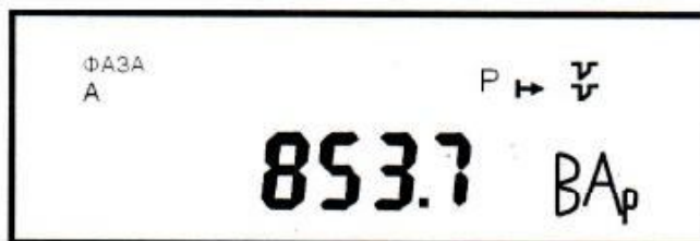
Рисунок 13 - Пример индикации значения реактивной мощности по фазе А (импорт)
