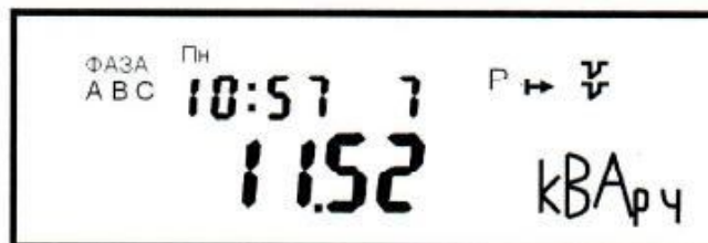
Рисунок 8 - Пример индикации текущего значения реактивной энергии (импорт)
