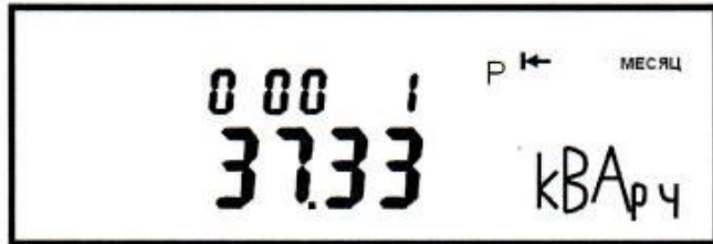
Рисунок 9 - Пример индикации значения емкостной реактивной энергии на РДЧ. В поле «Дата/Время» индицируется РДЧ
