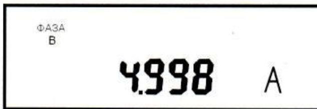
Рисунок 17 - Пример индикации среднеквадратического значения тока по фазе В
