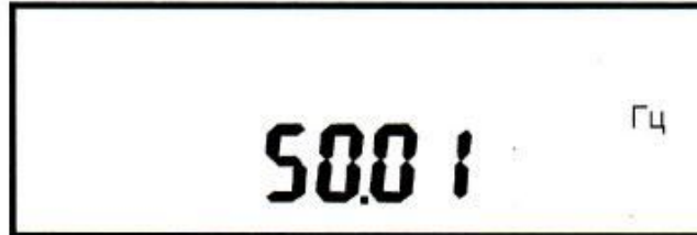
Рисунок 15 - Пример индикации значения частоты сети
