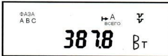
Рисунок 12 - Пример индикации значения суммарной активной мощности
