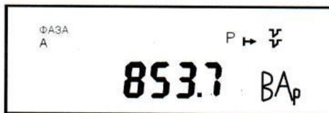
Рисунок 13 - Пример индикации значения индуктивной (положительной) реактивной мощности по фазе А
