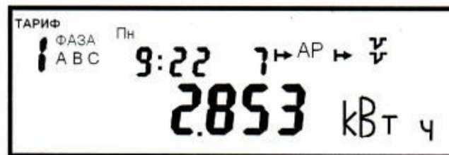
Рисунок 6 – Пример индикации текущего значения потребления энергии по 1 (действующему) тарифу, при наличии индуктивной реактивной составляющей полной энергии
