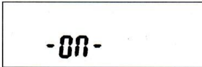
Рисунок 23 - Пример индикации готовности к работе оптопорта
