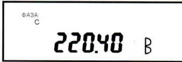
Рисунок 18 - Пример индикации среднеквадратического значения напряжения по фазе С
