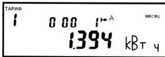
Рисунок 7 – Пример индикации значения потребления активной энергии на РДЧ по 1 тарифу (импорт). В поле «Дата/Время» индицируется РДЧ
