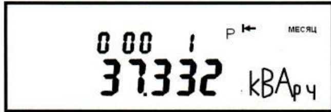
Рисунок 9 - Пример индикации значения емкостной (отрицательной) реактивной энергии на РДЧ. В поле «Дата/Время» индицируется РДЧ
