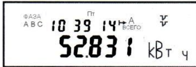
Рисунок 10 - Пример индикации значения суммарного потребления активной энергии по всем тарифам
