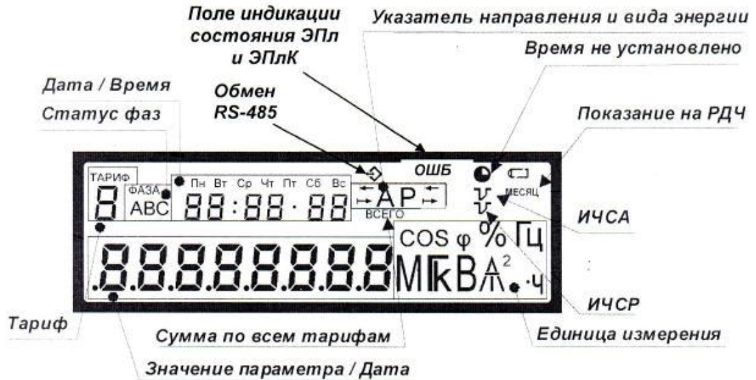
Рисунок 3 – Расположение полей дисплея счетчика
