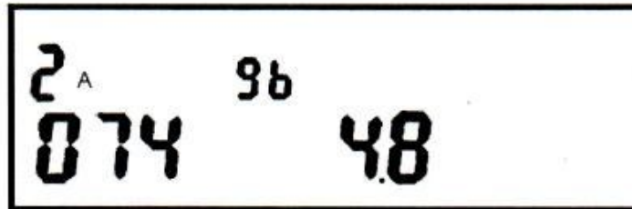
Рисунок 5 – Пример индикации параметров связи по интерфейсу RS-485 (интерфейс RS-485_2, адрес в магистрали RS-485 – 074, скорость обмена 4,8 кБод, режим 9-ти битной передачи данных)
