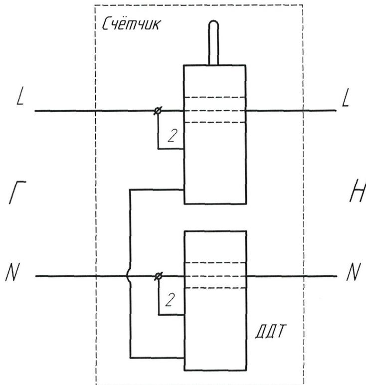
Рисунок 2 – Схема подключения счетчиков РИМ 189.15, РИМ 189.17
