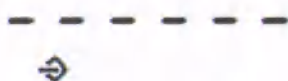
Рисунок А.45 – Пример индикации при отсутствии связи ДД со счетчиком и связь до этого не осуществлялась (все символы будут мигать)
