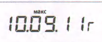
Рисунок Б.22 – Пример индикации даты фиксации максимального значения средней активной мощности в текущем отчетном периоде Ринт
