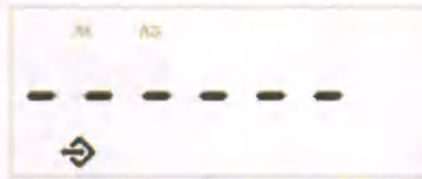
Рисунок А.49 – Пример индикации при отсутствии связи ДД со счетчиком (все символы будут мигать).
