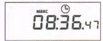
Рисунок Б.31 – Пример индикации времени фиксации максимальной активной мощности за последний закончившийся расчетный период (на РДЧ)
