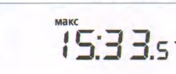
Рисунок Б.23 – Пример индикации времени фиксации максимального значения средней активной мощности в текущем отчетном периоде Ринт
