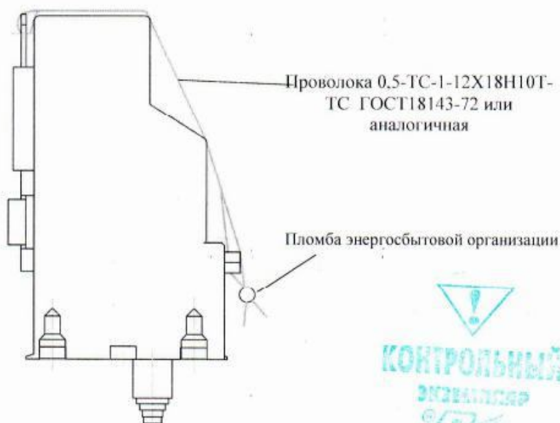
Рисунок Б.1- Места установки пломб Поверителя
