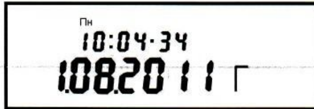
Рисунок Д.12 - Пример индикации текущей даты и времени ЧРВ счетчика
