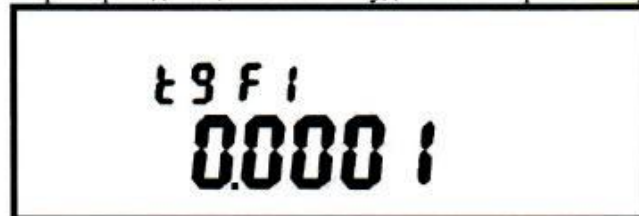
Рисунок Д.19 - Пример индикации суммарного значения коэффициента реактивной мощности цепи \text{tg } \varphi
