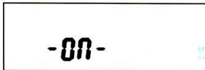
Рисунок Д.23 - Пример индикации готовности к работе оптопорта
