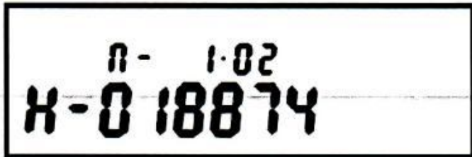
Рисунок Д.2 – Пример индикации номера версии и заводского номера счетчика (версия счетчика 1.02, заводской номер 018874)
