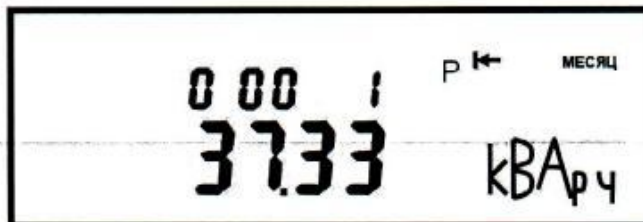
Рисунок Д.7 - Пример индикации значения реактивной энергии на РДЧ (экспорт). В поле «Дата/Время» индицируется РДЧ
