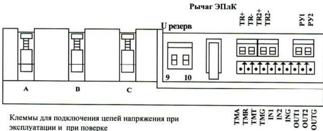
Рисунок Е.3 – Схема расположения контактов клеммной колодки счетчиков РиМ 489.13, РиМ 489.15, РиМ 489.17
