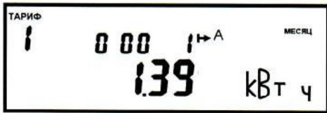
Рисунок Д.5 – Пример индикации значения потребления активной энергии на РДЧ по 1 тарифу. В поле «Дата/Время» индицируется РДЧ
