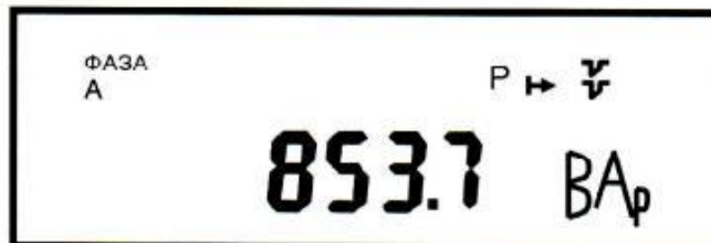
Рисунок Д.11 - Пример индикации значения реактивной мощности (импорт) по фазе А
