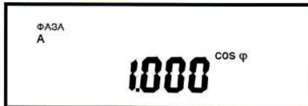
Рисунок Д.14 - Пример индикации значения коэффициента мощности по фазе А
