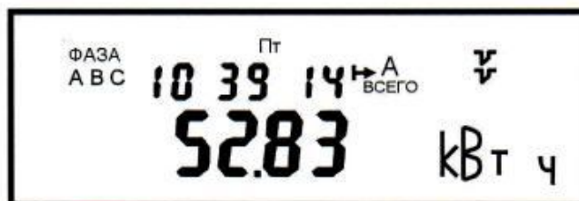
Рисунок Д.8 - Пример индикации значения суммарного потребления активной энергии по всем тарифам
