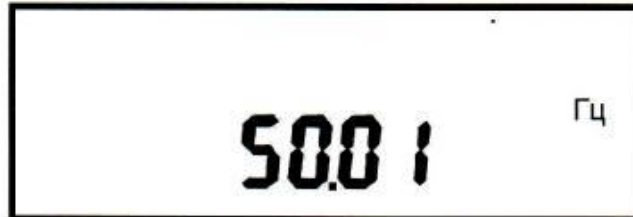
Рисунок Д.13 - Пример индикации значения частоты сети
