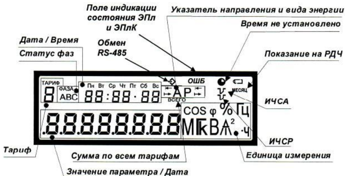
Рисунок Д.1 – Расположение полей дисплея счетчика
