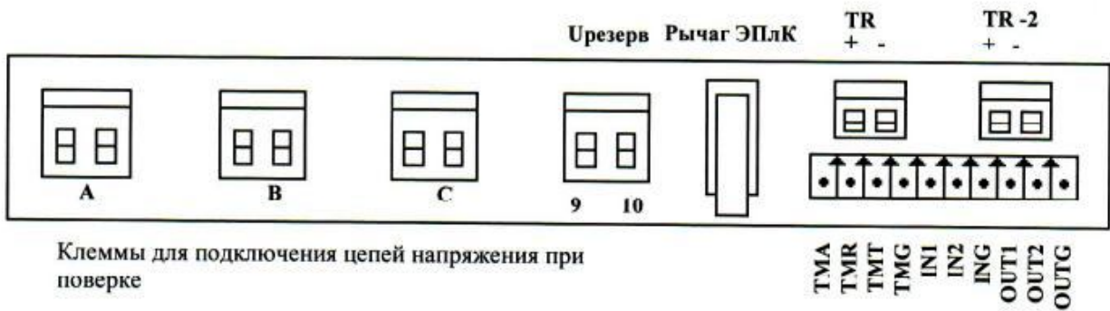
Рисунок Е.2 – Схема расположения контактов платы клеммников счетчиков РиМ 489.14, РиМ 489.16
