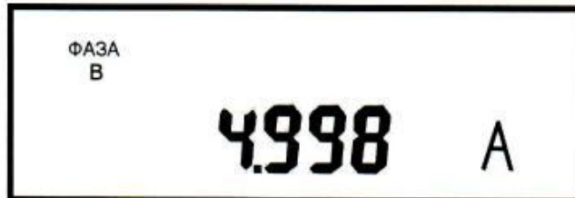
Рисунок Д.15 - Пример индикации среднеквадратического значения тока по фазе В
