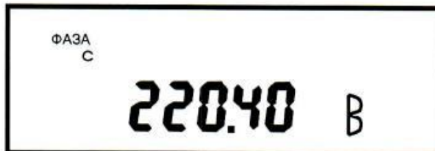
Рисунок Д.16 - Пример индикации среднеквадратического значения напряжения по фазе С
